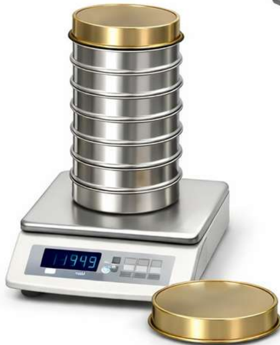
3. จัดชุด Test sieve-ตะแกรงร่อน สำหรับเตรียมพร้อมชั่ง
